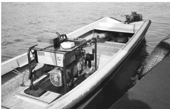
Slika 9. Čamac sa ugrađenim dizel motornim agregatom i naponsko frekventnim invertorom postavljenim na vrhu agregata
